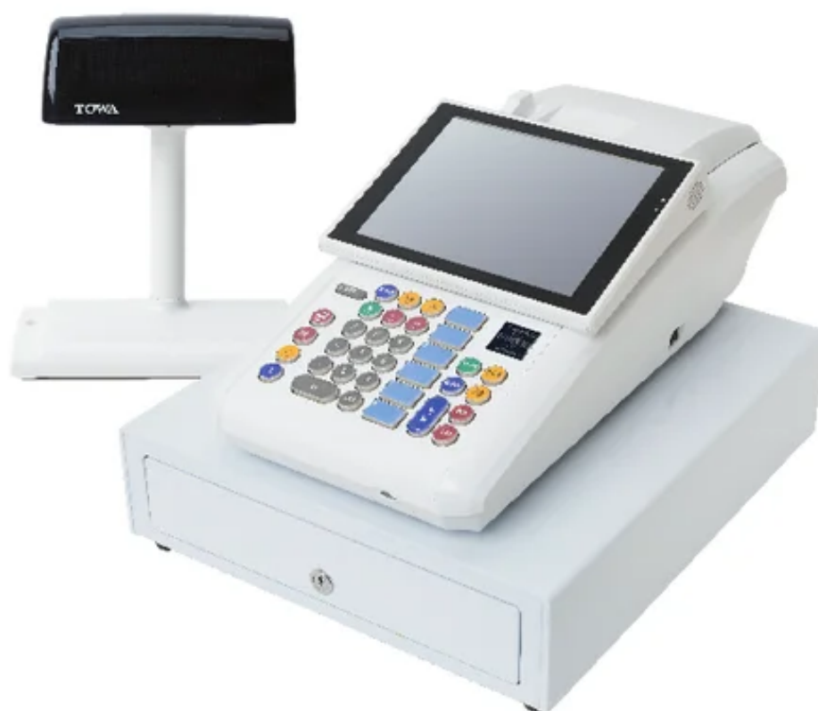
システム構成例（FT-800II本体+スタンダードドロア+客表示）
